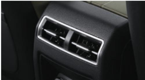
Lüftungsdüsen an der Mittelkonsole hinten
